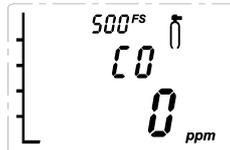
6. 当零点标定完成后，用磁棒点下'✓'键，确认零点标定完成。
