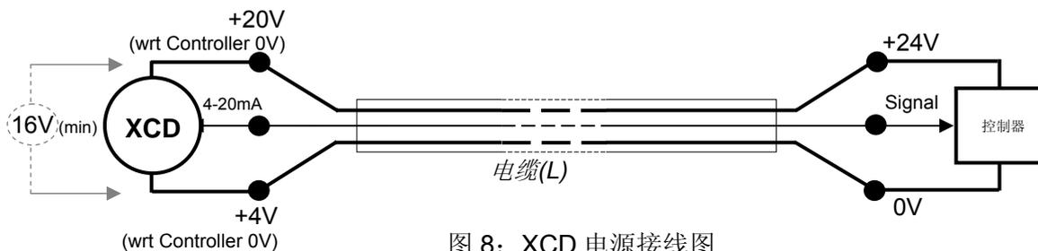
图 8: XCD 电源接线图
