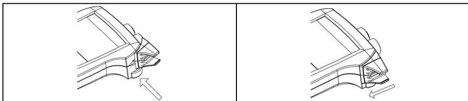
电极夹是一个电极的固定装置，可以安装在仪表外壳左右任意一侧。左右手都可进行仪表操作。
