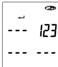
左图所显示的是安全密码设置页面，图中所显示的123数字是仪器原先设定的密码。如果不需要任何改变，按[▲]键前进至LEL标准气模式。如果需要更改密码，按[←]键，此时安全密码的第一个数值会闪烁，按[▼]和[▲]键更改第一位数字，更改完成后按[←]键确认，确认后跳到下一位数值，用同样的方法更改后两位数字。设置完成后屏幕上会以新密码显示，此时若按[←]键将返回安全密码设置模式，您可以重新设置密码；在数值闪烁时若按一次[⊖]键，即可返回到最初的安全密码设置页面，但所设置变更将不被保存。再按一次[⊖]键，仪器返回常规气体读数模式页面。若已设置安全密码，如果没有输入正确的安全密码，则用户就不能校准或对仪器设置做任何改动。如需校准仪器，用户首先需重新启动仪器，并进入设置模式，输入正确的安全密码。一旦正确的密码被输入，用户就能各项设置，或对仪器进行校准。
