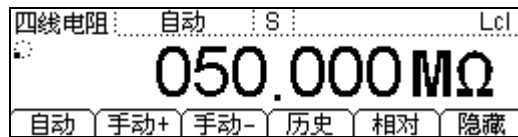
图 2-20 四线电阻测量界面
